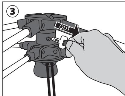
オレンジ色のピンを抜き、上下のハブのロックを解除します。
