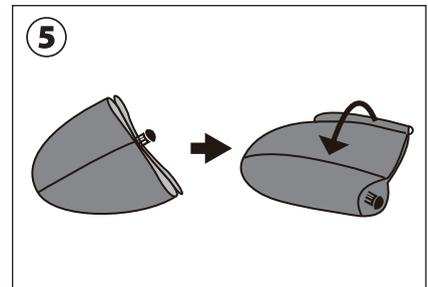
中央ハブを中心にサイドポールを集め、傘を畳む要領でポールを中心にきつく巻き上げたのち収納袋に収納します。水分や汚れをしっかりとふき取ったのち、乾燥した場所で保管ください。
