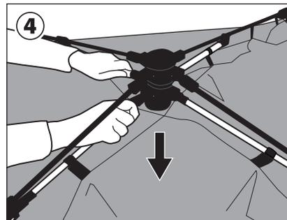
中央ハブからロープの出ている側に立ち、サイドのポールを下に押し下げる要領で上下のハブの接続を解除します。
