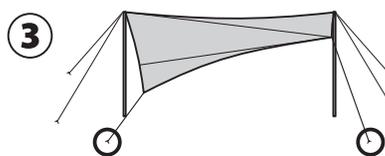
タープ四隅のループにガイロープ(短)を結びつけ、タープ本体上部の中心~タープ四隅の延長線上に伸ばし、張り縄の先端位置にペグを打ち込み、張り縄の先端をペグに引っかけます。
