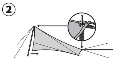
タープ先端のグロメット(はとめ)にセンターポールの先端をセットし、ガイロープ(長)の中央のループを通し、片側のセンターポールを地面に垂直に立たせるように起こします。
