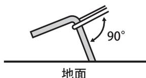
ロープに対して90°になるようにペグを打ち込むと、安定してロープを設置する事が出来ます。
