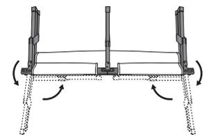
両端の脚を矢印の方向に回転させます。
