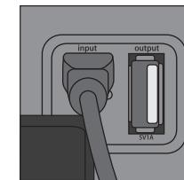
本体とパソコンなどを付属の充電用 USB ケーブルで接続してください。(本体の USB ポートにはマイクロ USB 側を挿入してください。) 充電ランプが緑に点灯し、充電が始まります。充電ランプの点滅が終了したら充電完了です。
