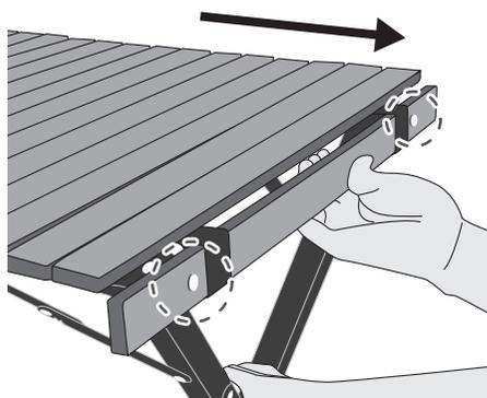
フレームの突起部分に天板の端にある穴をはめ込みます。
