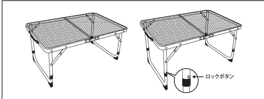
テーブルの向きを変え、完成です。お好みに合わせて脚の高さを2段階に調節してください。
