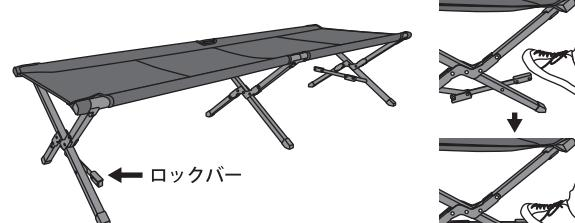
フレームが開ききったら、2カ所のロックバーを足で押し下げ、組立完成です。
