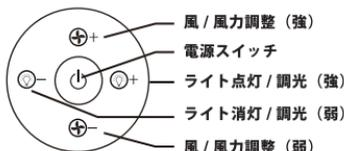
リモコンが使用できない場合は、本体が充電されているかどうか確認してください。本体が充電されているにも関わらずリモコンを使用できない場合は、インジケータの点滅が消えるまでリモコン側の扇風機+マーク長押し、本体とリモコンの再ペアリングを行ってください。ペアリングが完了すると、インジケータの点滅が消灯します。
